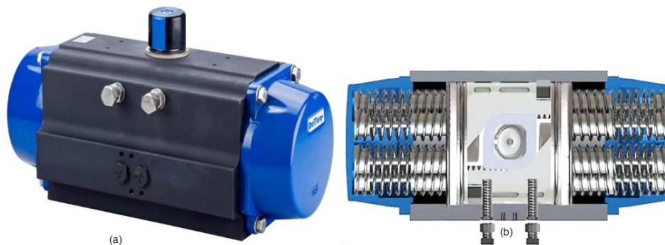
Figura 8. (a) Estructura externa del accionador neumático de piñón y cremallera de doble efecto y retorno a resorte, Delval Serie 21, y (b) estructura interna del accionador.
