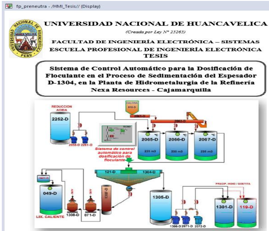
Figura 28. Interface principal del sistema de control automático para la dosificación de floculante en el proceso de sedimentación del espesador D-1304.
