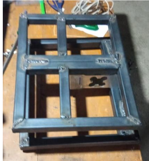
Fotografía 2. Instalación del sensor de peso
